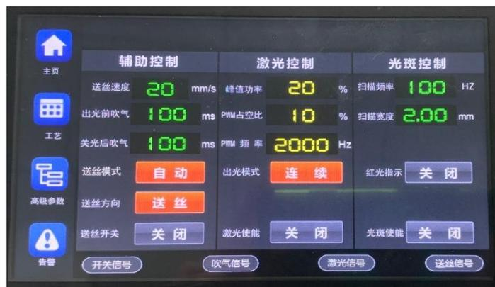
$$\text{焊接头的出光功率} = \text{激光器功率} \times \text{峰值功率} \times \text{PWM 占空比}$$
