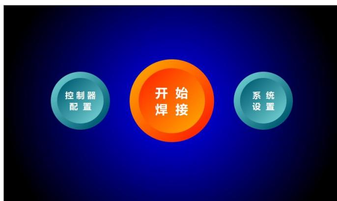
系统上电初始化完毕后默认进入焊接工作界面，点击“主页”按钮进入主页界面，在主页界面下可以进入系统设置、开始焊接、控制器配置界面。
