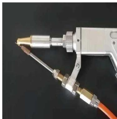
将送丝头固定 II 序持焊头上。
