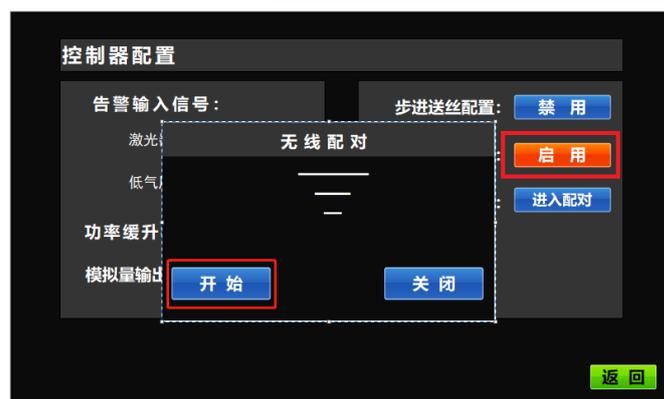
3) 短按“OK 键”，将三角光标移至“无线配对”行，长按“OK 键”进入配对模式，当检测到处于配对的 HWS 5000 控制器时就会配对成功。
