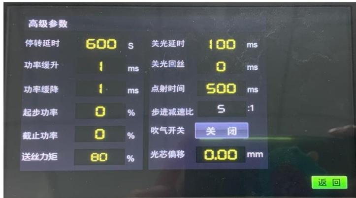
**停转延时：**在激光使能开启的情况下，停止出光后，电机经过该段延时后停止转动，停转延时最高为 999s。
